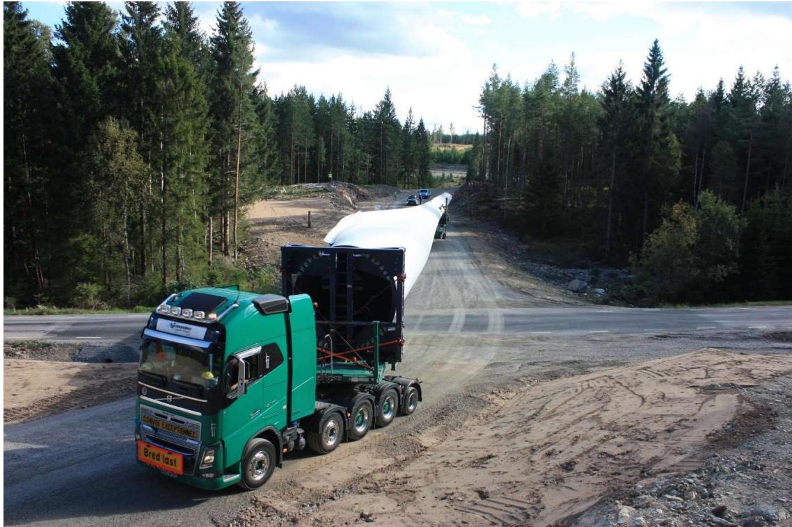
Figur 14 De stora transporterna ställer särskilda krav på vägarnas utformning i området. Bilden visar transport av ett rotorblad i en vindpark i Östergötland
